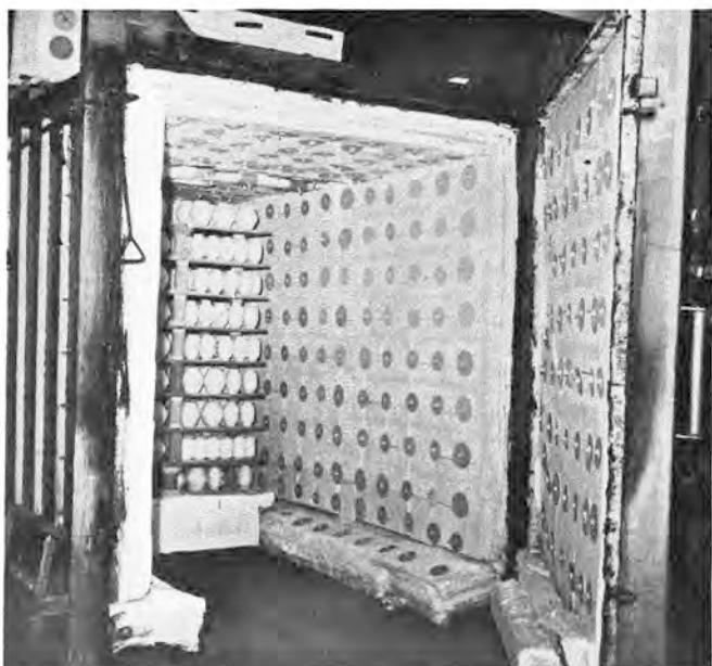
Fig. 1: Vista general del horno, con un carrito en posición, en la que pueden verse los cierres estancos engoznados de tipo banco, en la posición "abatida".
